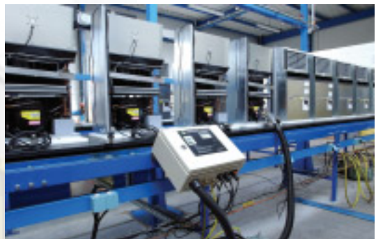
Apparat för påfyllning av köldmediet R 404 a
