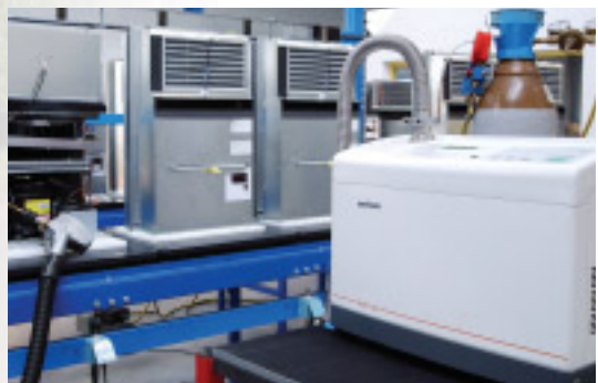
Spektrometer för spårning av läckage
