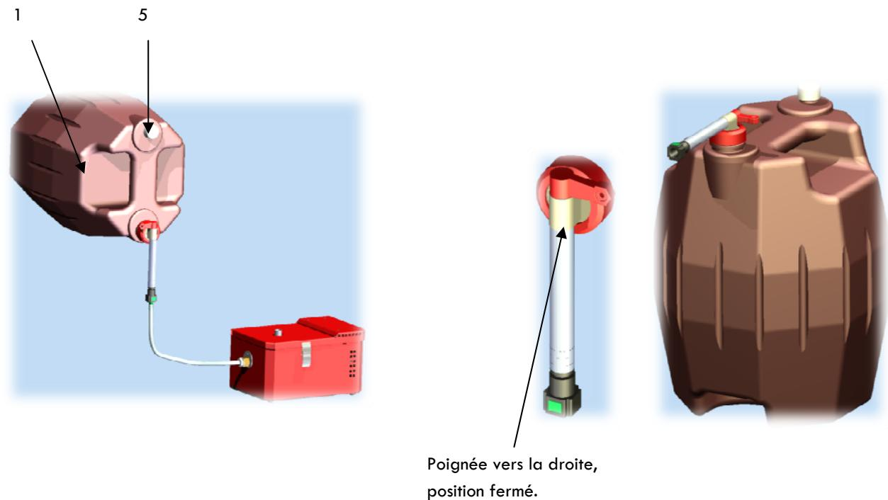
1. Positionner le réservoir à l'horizontale.
