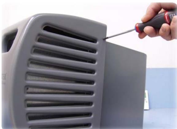
Lossa de 2 skruvarna på båda sidor av klimatanläggningen
