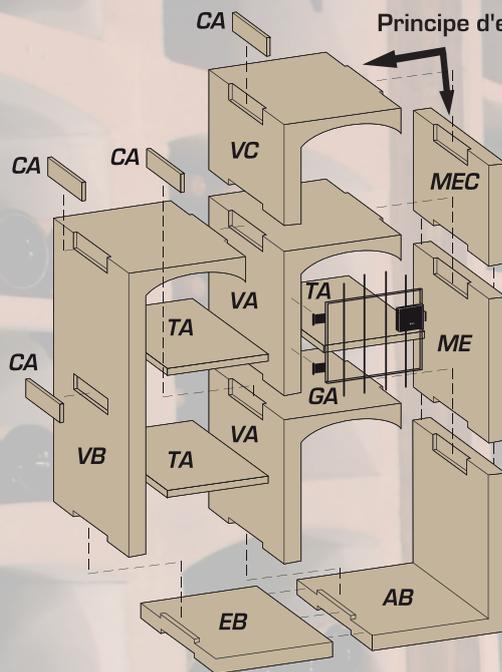
Principe d'emboîtement autobloquant
